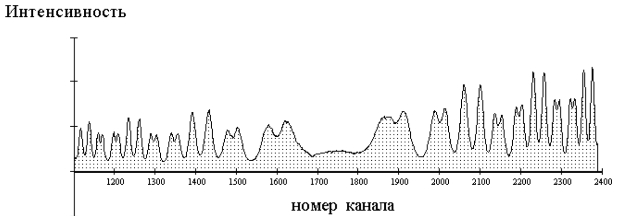
Рис.6.Интерферограмма спектральной линии \lambda = 4722 \text{ \AA} , H \neq 0 .
